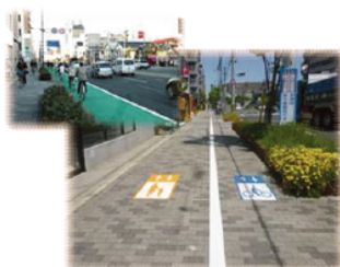
安全で快適な自転車利用環境を目指し自転車通行帯を整備
